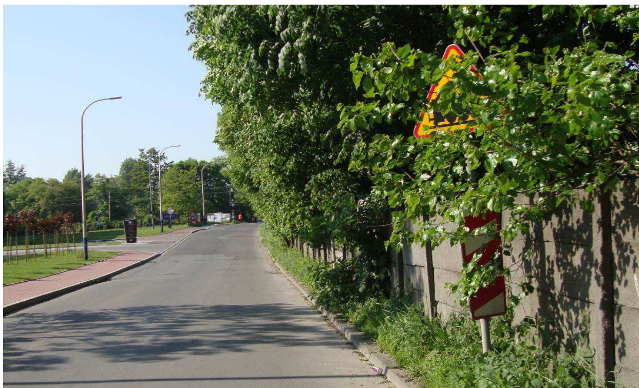
Zdjęcie nr 10. Przejazd kategorii C w km 1,405 linia nr 942. Niewidoczny znak A-10 i wskaźnik G-1a.
